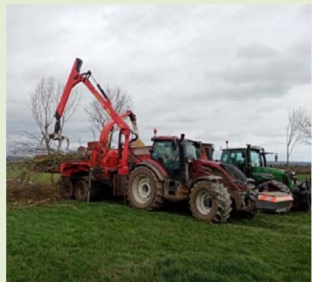
Paysage du bocage de la Manche (50) et travaux de broyage de haies au moyen d'une déchiqueteuse afin de produire du bois déchiqueté. Crédit : Haiecobois.
